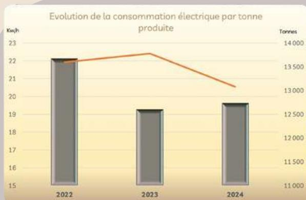
**Réduction** de 12% de notre **consommation énergétique** en travaillant sur notre process : arrêt des machines durant les pauses, temporisation de marche à vide et diminution de la pression d'air.
